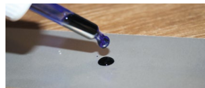
Test s tintom: Stavite kapljicu tinte na anodiranu površinu i obrišite je krpom koja upija vlagu
