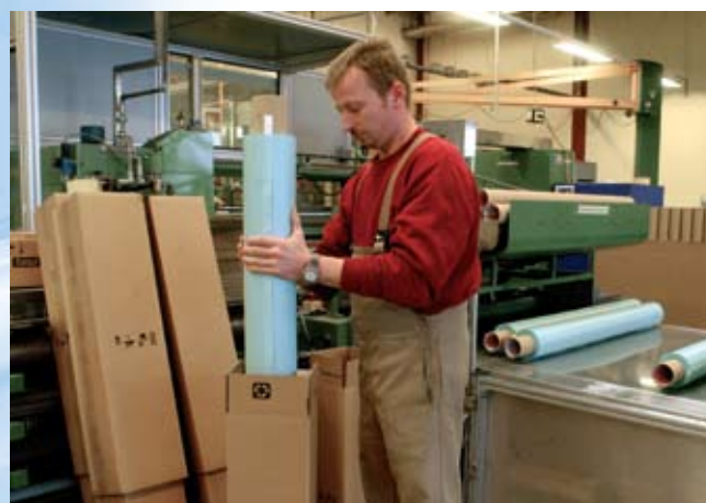
Fixiranje krajeva rola s tesom Duct trakom 4662 osigurava lagano rukovanje tijekom pakiranja. Nema opasnosti od odmotavanja tijekom transporta.
